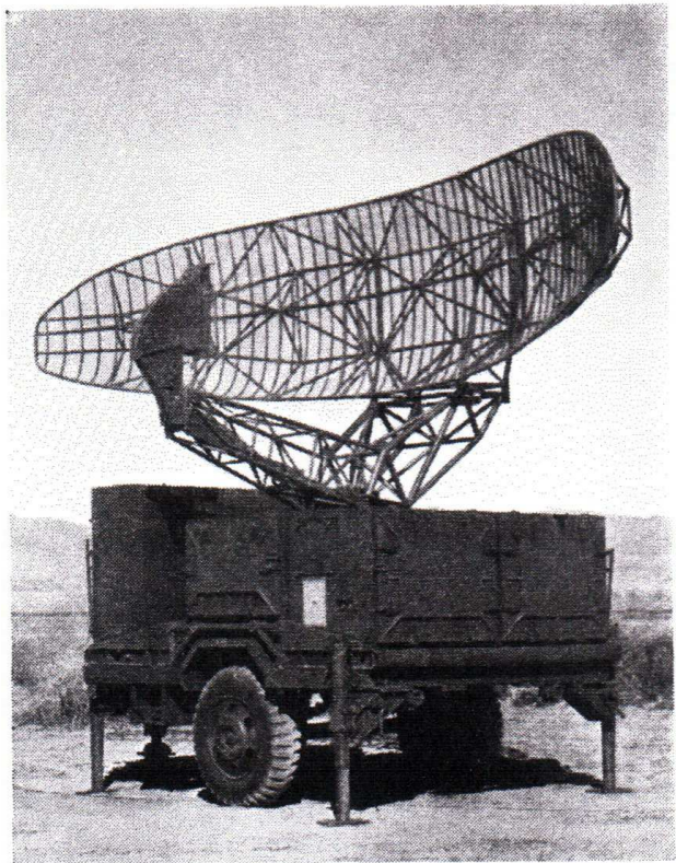
HAWK pulse-søgeradar. Som alt HAWK-materiel er også denne radar opbygget på påhængsvogn, således at eskadrillerne hurtigt kan flyttes til et nyt aktuelt område.
