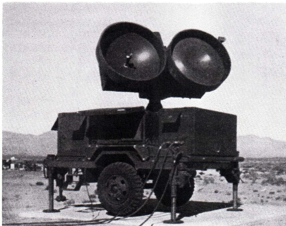
HAWK belysnings-radar er også af CW-typen. De to antenner er her anbragt ved siden af hinanden med senderantennen til venstre.
