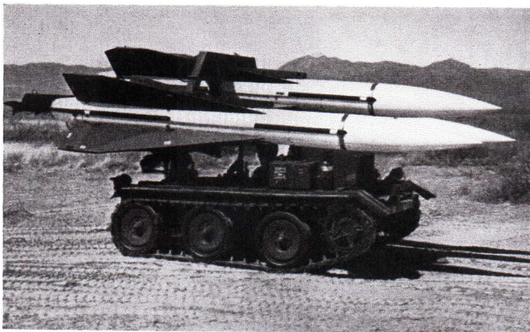
Bæltedrevet og terrængående HAWK rakettransportkøretøj forsynet med hydraulisk løfte-system, således at af- og pålæsning af raketter kan udføres på få øjeblikke.
