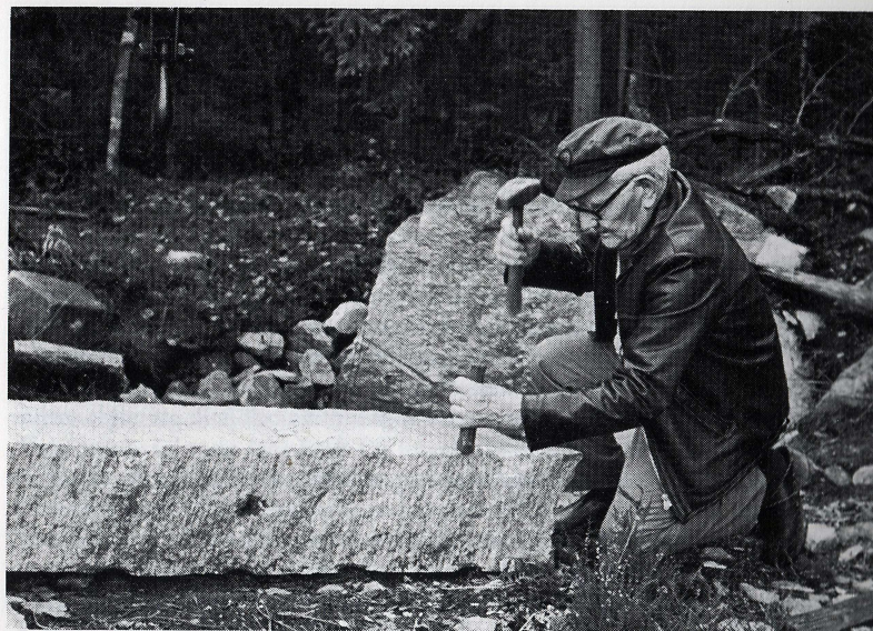
Fredrik Johansson hugger en kant med hammare och kantjärn. Foto: Paul Ullerås
